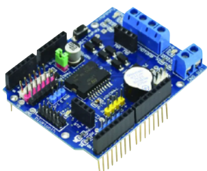
Shield interface de puissance Pour 2 moteurs à courant continu (2 sens de rotation) 22,68 €
