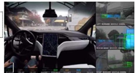
Huit caméras panoramiques (1, 3, 4, 5) offrent une vision à 360° autour du véhicule. Douze capteurs à ultrasons (2) détectent les objets à proximité immédiate pour éviter les chocs. L'ordinateur de bord (Figure N°2) basé sur l'intelligence artificielle développée par Tesla traite les informations pour informer le conducteur grâce à l'écran et communiquer les ordres de pilotage par des faisceaux de fils électriques.
